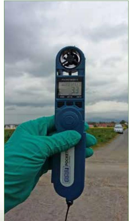
Abb. 9: Messgerät zur Erfassung der Windgeschwindigkeit (Foto: RP Gießen, PSD)
